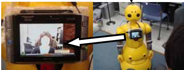
Fig.1 ヒューマノイドロボットアバターシステム
